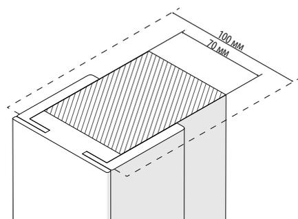
толщина стены от 100 мм, с использованием соединительного элемента и добора
